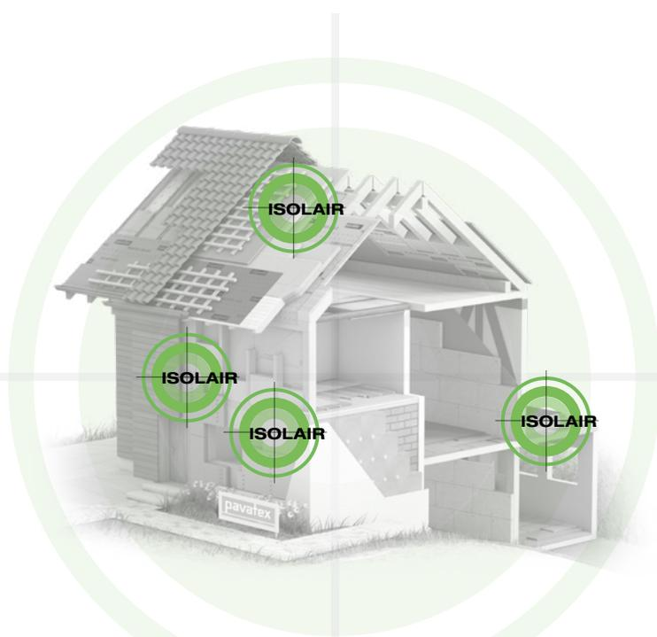
**PRAXIS-Beispiel:** Sie verwenden die bewährte PAVATEX Unterdeckplatte ISOLAIR 60 mm für das Dach – und jetzt soll noch eine verputzte Gaube ausgeführt werden. Die schnelle und praktische Lösung: Verwenden Sie einfach die gleiche Platte als Putzträgerplatte mit WDVS-Zulassung.
